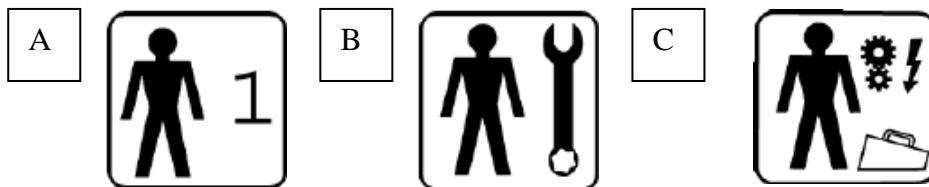
[A] **Оператор:** работник, обученный и допущенный к работе с аппаратом. Для понимания приложенных инструкций (текста и рисунков) оператор должен иметь (или получить за счет надлежащего обучения и подготовки) следующие характеристики:
